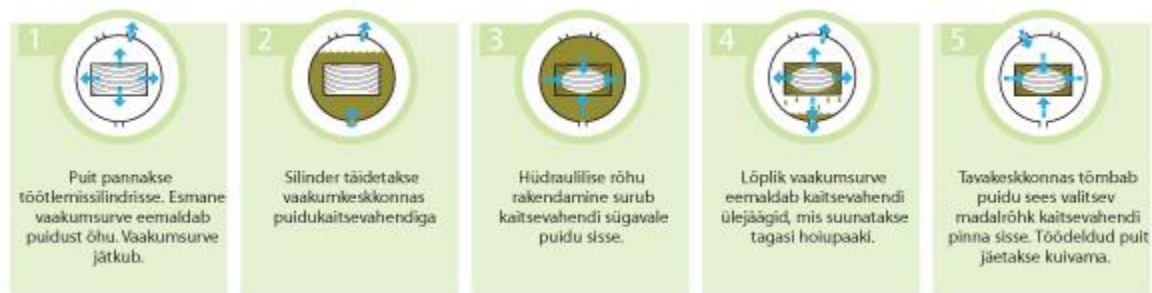
Joonis 4. Puidu immutusprotsessi skeem. Allikas: Lotus Timber OÜ.
